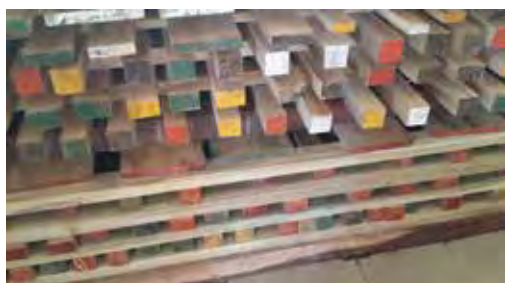
Figura 4. Estiba de secado con listones de 2200 mm de largo y de tres secciones: 50 x 50 mm, 20 x 150 mm y 20 x 40 mm identificadas por árbol correspondientes a un clon selecto.
