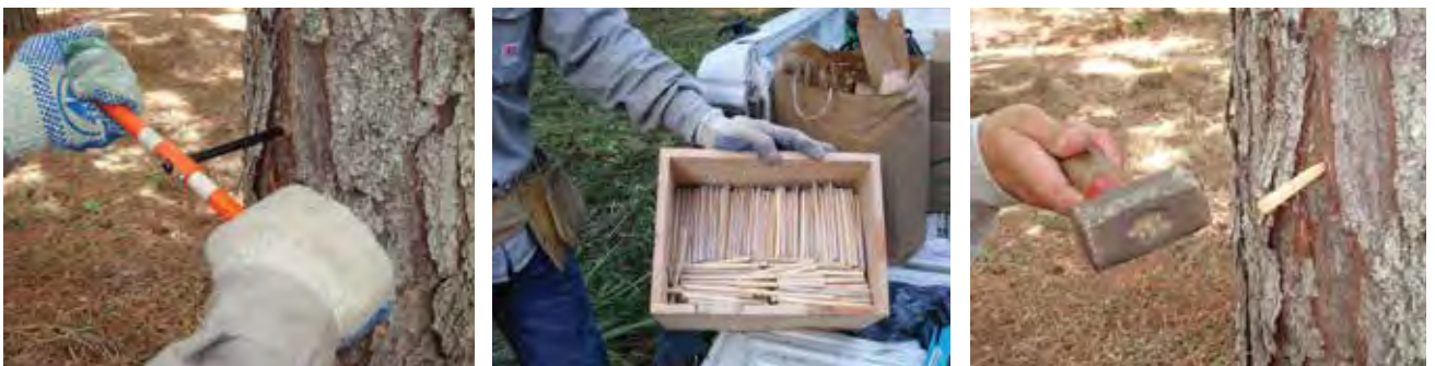
Figura 8. Procedimiento de muestreo de tarugos y posterior sellado de orificio originado por la extracción de tarugo.
