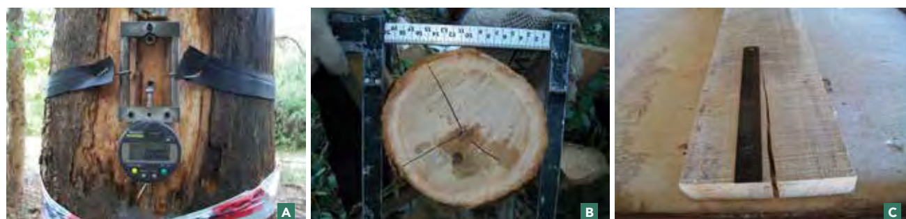
Figura 24. A) Extensómetro CIRAD-Forêt sobre árbol en pie B) Rajaduras en la cara transversal de un rollizo C) Medición de la longitud de una rajadura en extremo de tabla.
