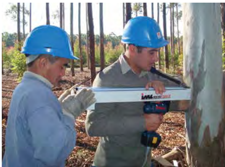
Figura 20. Medición de la Amplitud radial con el Resistógrafo
