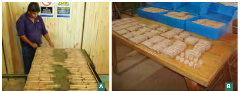
Figura 23. Listones diametrales (A) y probetas preparadas para evaluar densidad de la madera (B).
