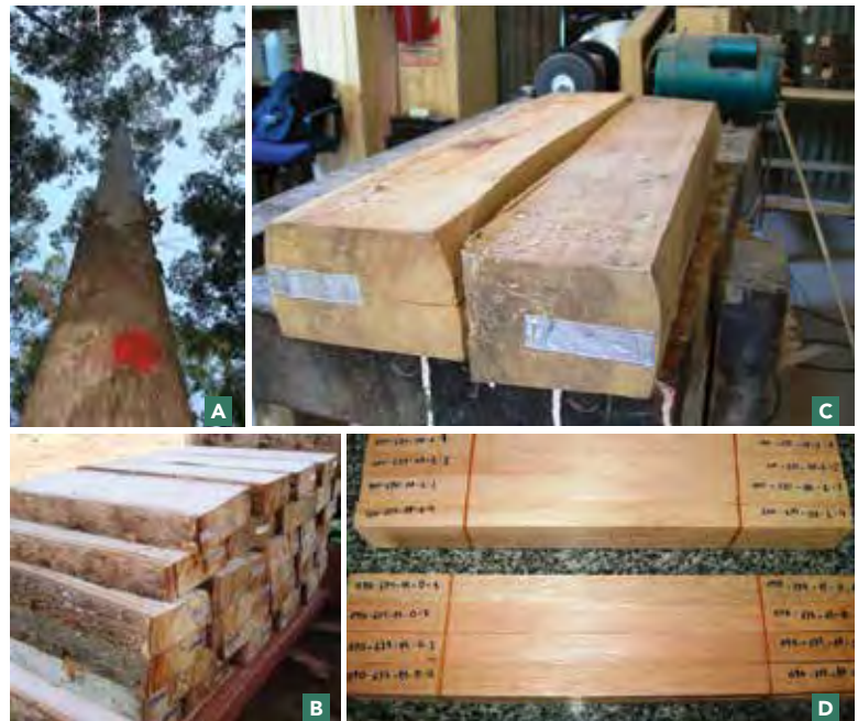
Figura 19. A) vista de un árbol seleccionado en el ensayo ubicado en Cerro Azul (Mnes.) , B) tabloncillos centrales en proceso de estacionamiento bajo cubierta, C) tablón central dividido en sentido radial y D) probetas de 2 cm x 2 cm x 36 cm (Norma DIN 52186) correspondientes a diferentes posiciones radiales listas para realizar los ensayos mecánicos.
